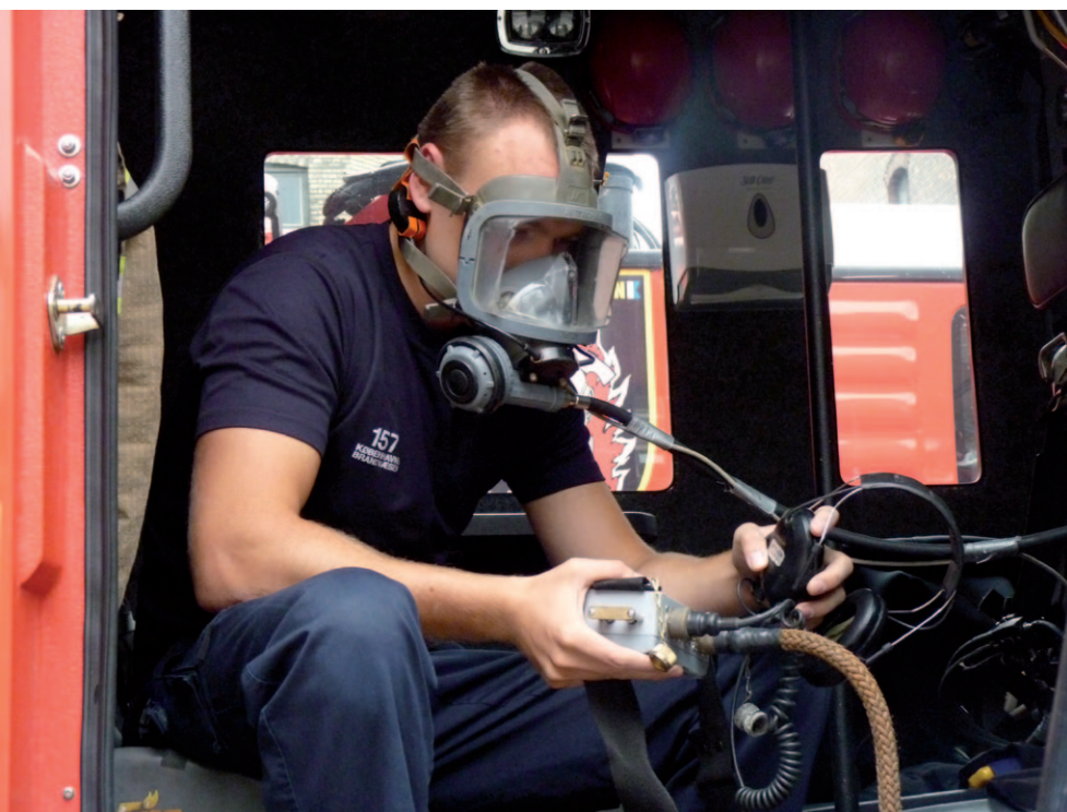
Martin Nebelung tjekker materiellet for skader - her er det iltmaskerne og slangerne, der efterses.
